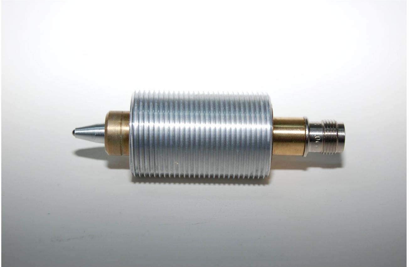
**Befestigung:** Die Körperschallaufnehmer können entweder durch eine flächige Klemmung des Gehäuses oder über das am Gehäuse vorhandene Gewinde M27x1,5 befestigt werden (eine Kontermutter M27x 1,5 gehört zum Lieferumfang).
