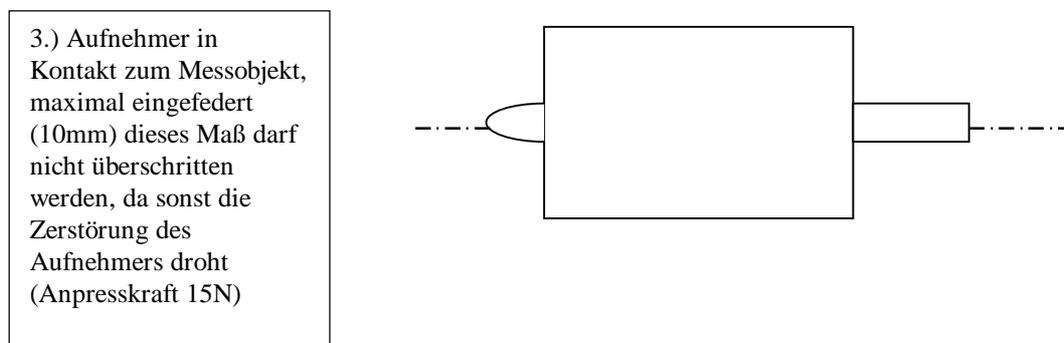
Der maximale Federweg von 10mm darf nicht überschritten werden! Die Aufnehmerspitze kann zwar noch weiter in das Gehäuse eingefedert werden, dies dient jedoch nur als Sicherheitsreserve und nicht als Betriebsstellung.
